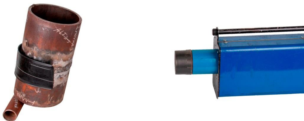
Рис. 1. Схема расположения рентгеновского аппарата МИРА-2Д и контролируемого сварного соединения труб
