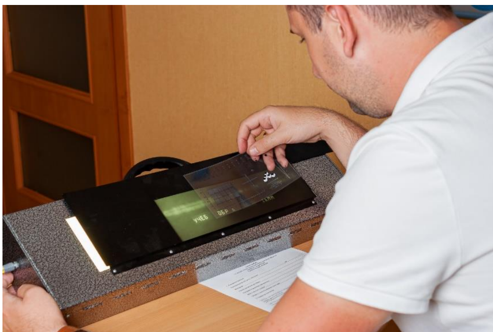
Рис. 3. Расшифровка радиографических снимков с помощью негатоскопа и трафарета
